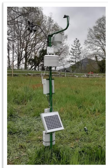
Figure 1 – micro-capteur de particules et balise météo avec leur panneau solaire et système de communication ( ©Agriscope )
