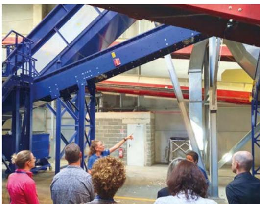
Pour aller toujours plus loin dans la captation des matières recyclables, le nouveau process inclut douze robots de tri, trois cribles balistiques, deux courants de Foucault, un crible à disque, deux overbands...
