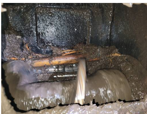
Tronc observé sur un des racleurs de presse.
