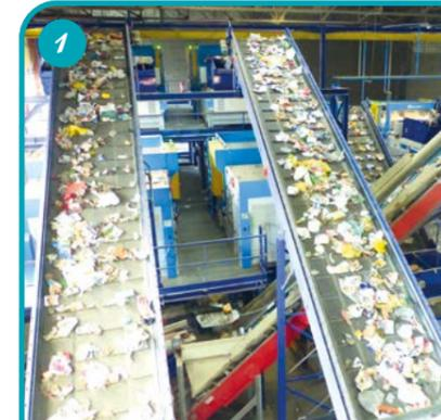
Après un premier contrôle effectué par les agents au déchargement pour enlever les erreurs les plus visibles (meubles, pare chocs, sièges auto...), les déchets passent par le trommel (tamis cylindrique rotatif permettant de trier les matériaux en fonction de leur taille), puis par un véritable circuit de 2,5 km de tapis, lancés à 10 km/h. Plus de 25 machines (trieurs optiques, trieurs magnétiques, courant de foucault...) vont successivement les séparer selon leur matière.
