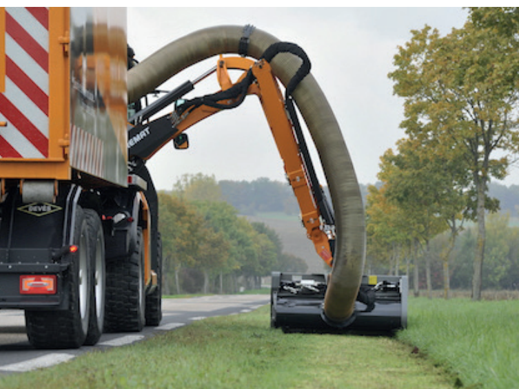
Fauchage de bord de route avec exportation par aspiration (source : Norem)
