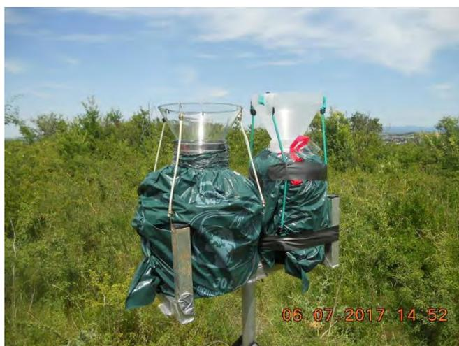
**Photographie 2 : Les jauges en place et le système de fixation des entonnoirs.**
