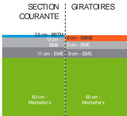
BBME : béton bitumineux à module élevé
