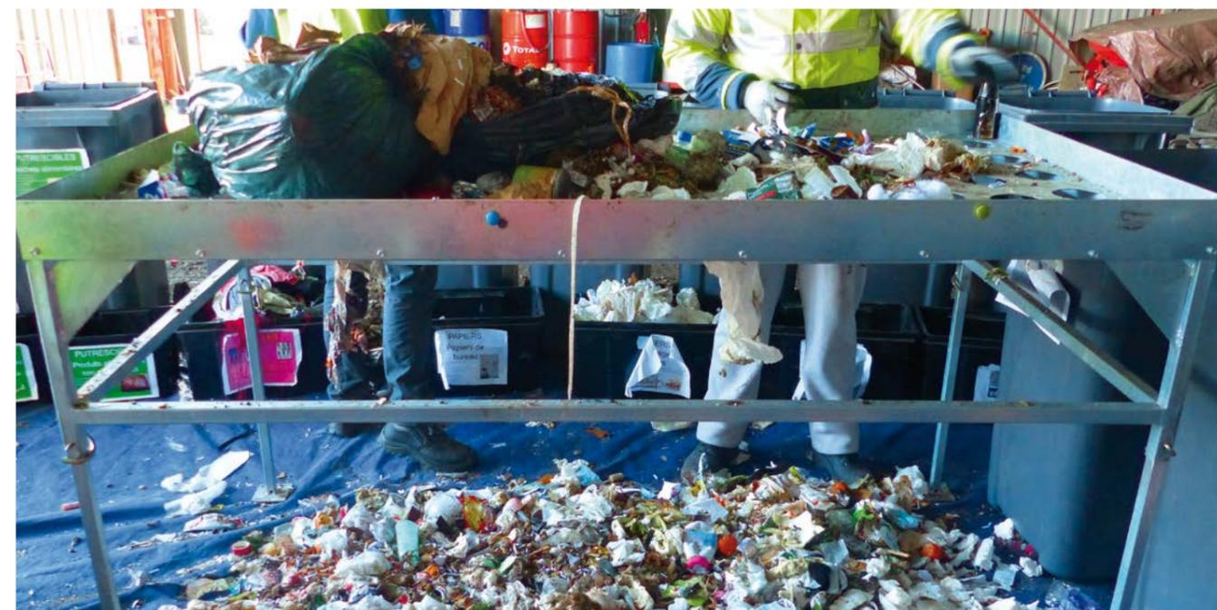
L'ensemble de l'échantillon à caractériser est passé sur une table de tri à trous de diamètres 100 mm et 20 mm, conformément à la norme.
