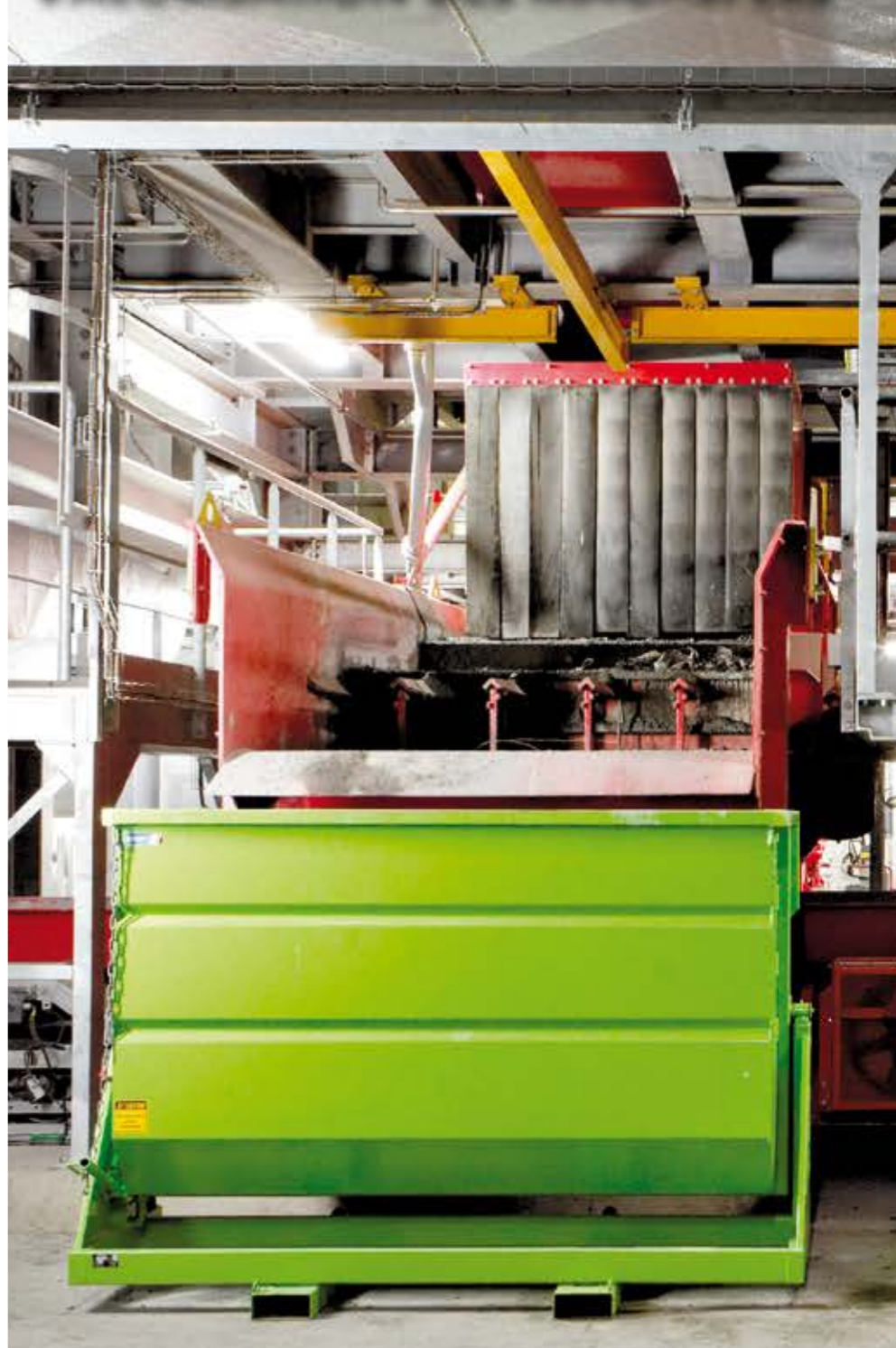
A la sortie du four, les résidus de l'incinération (mâchefers) sont déferrailés, triés, criblés, maturés et analysés avant d'être valorisés en sous-couche routière.
